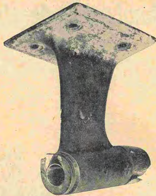
Billedet viser den udvendige Akselbærer og Metallejet fra den hurtiggaaende Motorbaad „Aquamobile“, saaledes som Bæreren og Metallejet saa ud efter kun 3 Ugers Sejlsads. Som De vil bemærke, har Akslen slidt sig gennem Metallejet og et godt Stykke ned i Akselbæreren. Ydermere har Akslen sprængt Muffen. Den hvide Cirkel er afsat for at vise den oprindelige indvendige Diameter af Metallejet. I Betragtning af at Gummilejet har været anvendt hele Sommeren uden at slide hverken Akslen eller Foringer, og der sikkert vil gaa endnu mange Somre, inden der kan konstateres noget Slid, er denne Akselbærer et udmærket Bevis for Gummiforingernes økonomiske Fordele.
