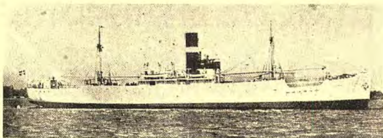
Damperen „Estrid“, bygget i Helsingør og forsynet med Spildedampsturbiner
