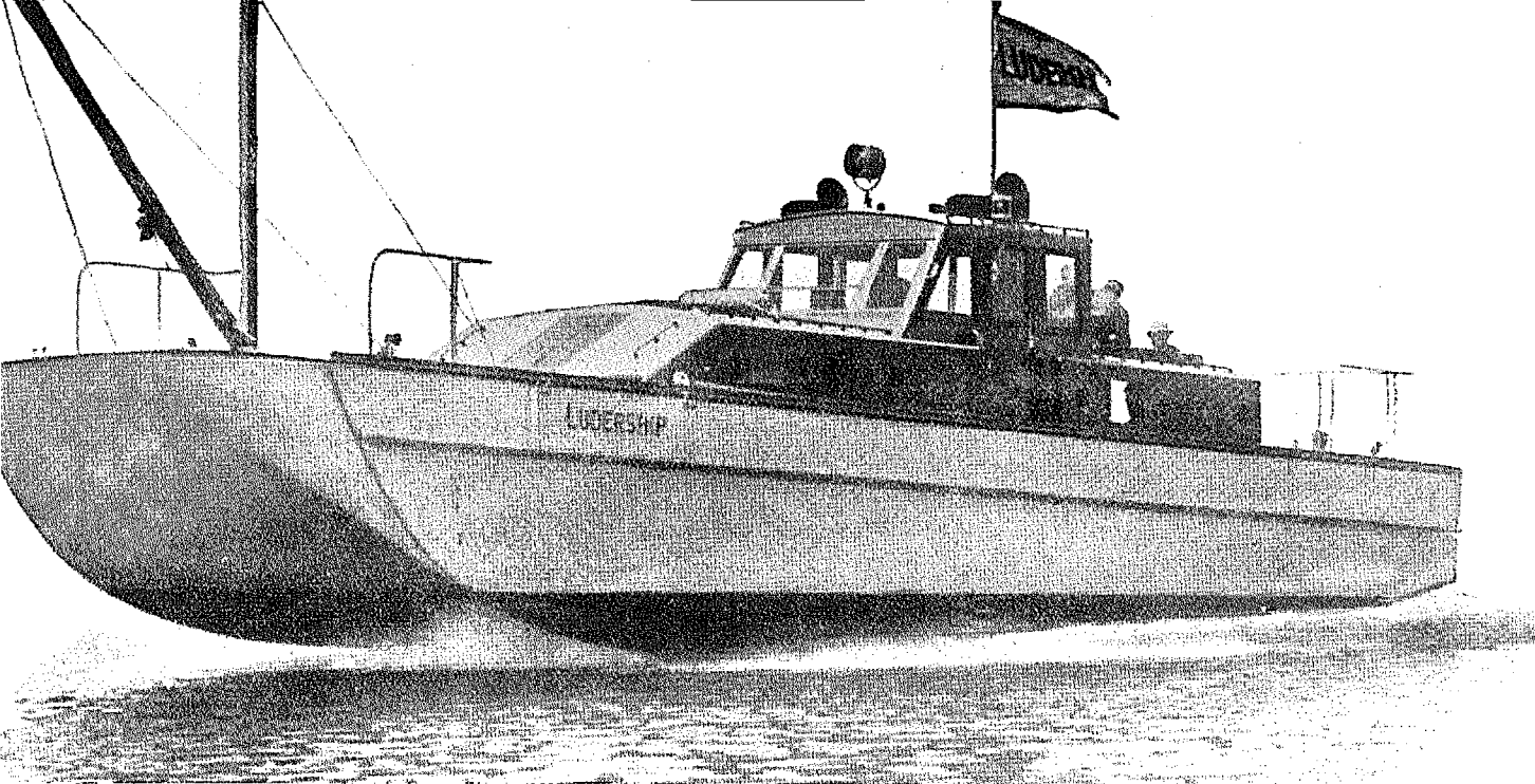
Hurtiggaaende amerikansk Marine-Motorbaad i Søslædeform. Baaden er 15 m lang, forsynet med 4 Motorer paa hver 300 HP. Den kan løbe 45 MI. Denne Baadtype anvendes som Sikkerhedsfartøj ved Marinens Flyveskoler. Den lille Kran paa Forskibet er beregnet til at holde havarerede Luftfartøjer oven Vandet!
