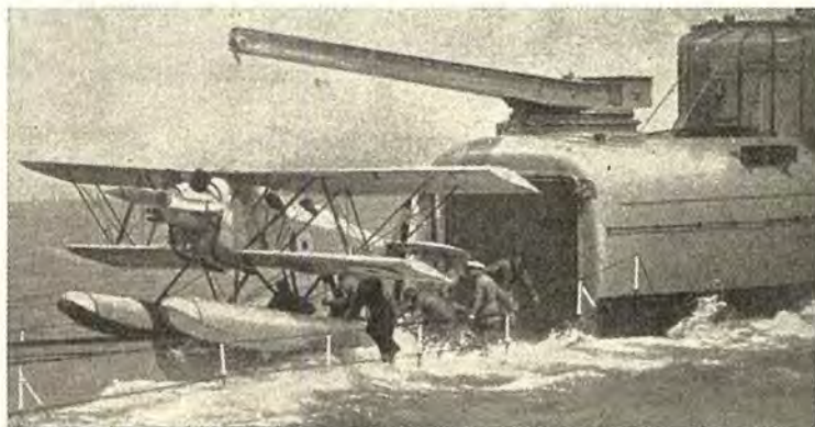
Den franske U-Baad „Surcouf“ med Flyvemaskinehangar agten for Taarnet.
