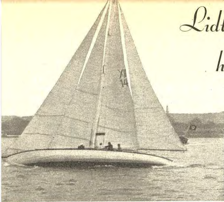
Forsøgs-Yacht bygget af Metal og forsynet med en hel ny Type Rigning, der skal være fordelagtig paa Indlandssøer.
