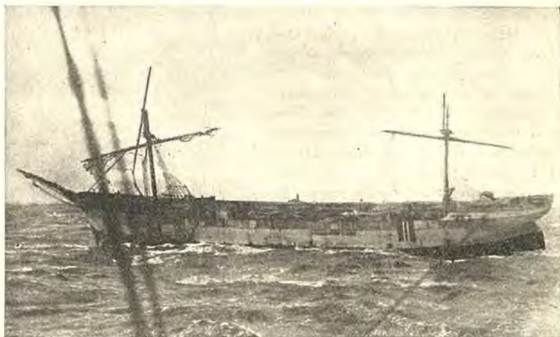
Jernfuldkib „Svaland“ ex. „Scottish Moors“, bygget i Stockton 1890, 2388 BT., 3600 T. DW. Bygget til W. H. Ross & Co., senere solgt til Norge, Fotografiet viser Skibet med smidt Rig ud for N. Y., blev slæbt ind dertil, og i Stedet for at faa ny Rig blev der installeret 2 kraftige Motorer og „Svaland“ rigget som 4-mastet M.-Sk., December 1922 solgt til Ophugning i Hamborg for 40,000 Kr. (Fra Lods Gruelunds Samling).
