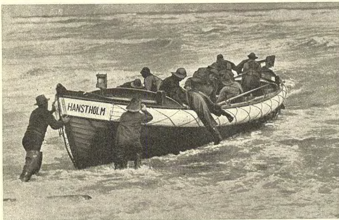
Dansk Motor-Redningsbaad, 10,3 m, saakaldet Kystmotorredningsbaad, til Udsætning og Landing paa aaben Kyst, forsynet med 32 HK Fordson Motor og alle moderne Hjælpemidler. (Gaar ud paa Øvelse ved Hanstholm; bemærk at Baaden sættes ud med Agterstævnen først).
