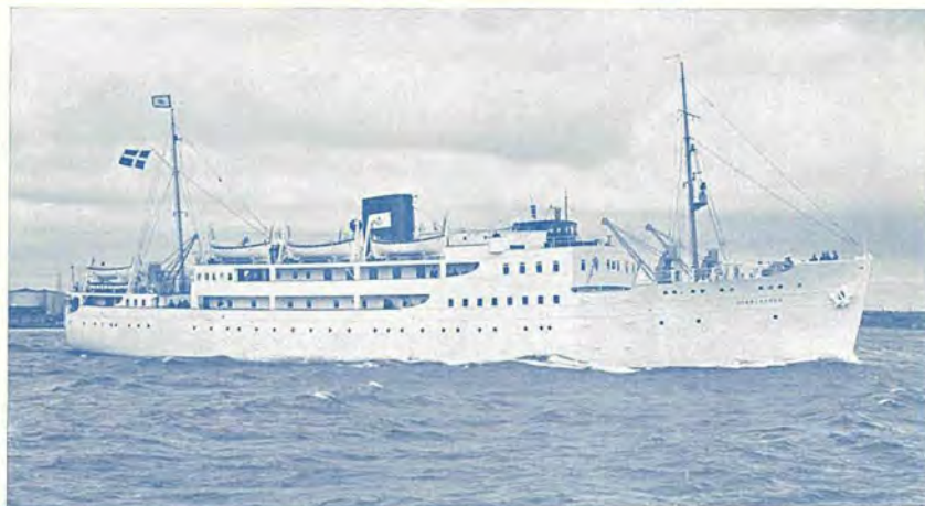
M/S „HAMMERSHUS“, Dampskibsselskabet paa Bornholm af 1866, Renne, er udrustet med THRIGE helelektriske Styremaskine og THRIGE Dæksmaskineri, Dynamoer og Motorer
