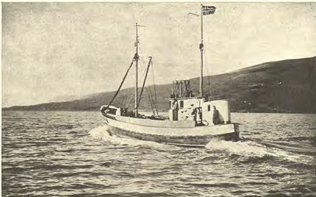
Islandsk Fiskekutter forsynet med 90 HK „Alpha“ Dieselmotor.
