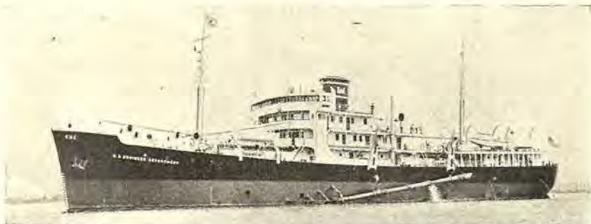
Muddermaskinen „Chester Harding“. Man ser det ene Sugerør langs Skibssiden.
