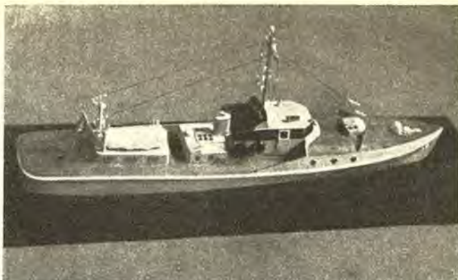
Fig. 9. Model til en 35 ts Baad med hensigtsmæssig Form.
