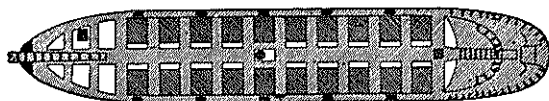
Fig. 14. Model af en Baad fra en ægyptisk Grav set fra oven visende den langskibs Dæksbjælke fra Stævn til Stævn. — Cairo Musæet No. 4798.
