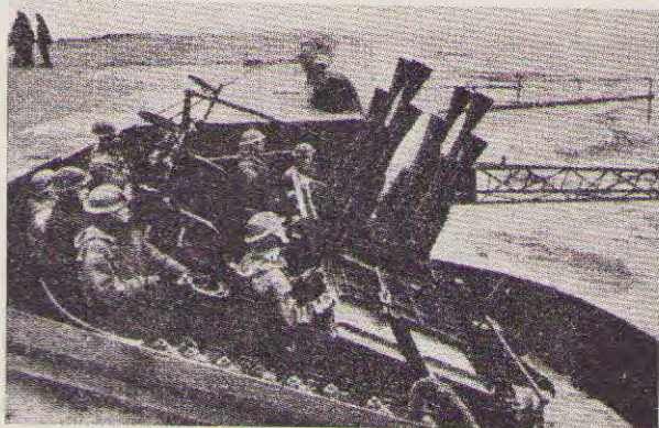
Fig. 12. Engelsk 40 mm Automatkanon med otte Piber af Model Vickers, opstillet paa et Hangarfartøj. Udgangshastigheden er lavere end ved Boforskanonen. Ildhastigheden kan antagelig for en kortere Tid komme op paa 25 Skud/Sek. P = 1 kg. Kanonen er vanskelig at manøvrere, er ustabiliseret og har kun enkelt Ringsigte som Hjælpemiddel.
