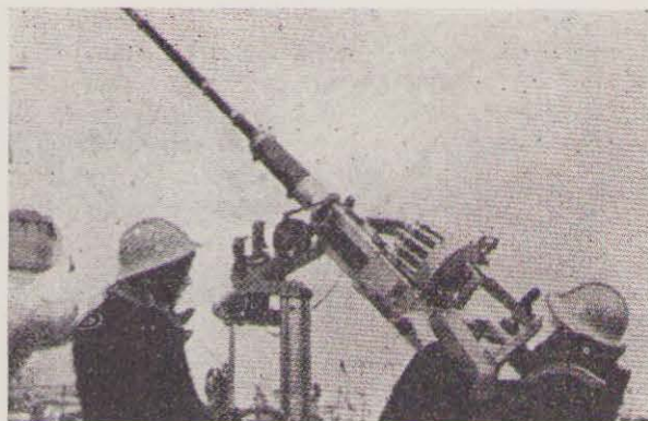
Fig. 15. Den svenske Flaades almindelige 20 mm Automatkanon, som forekommer paa saa godt som alle Fartøjs-typer. Den er opstillet triaxialt, har Ringsigte og kan betjenes af en eneste Mand. Ildhastigheden er 360 Skud/Min., og der findes Magasiner med 25 og 60 Skud. V_0 = 815 m/Sek., P = 0,140 kg.
