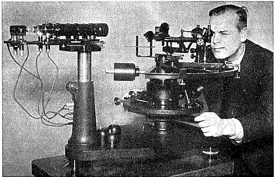
En Undersøgelse af Sekstant i Sekstantundersøgesapparat.
