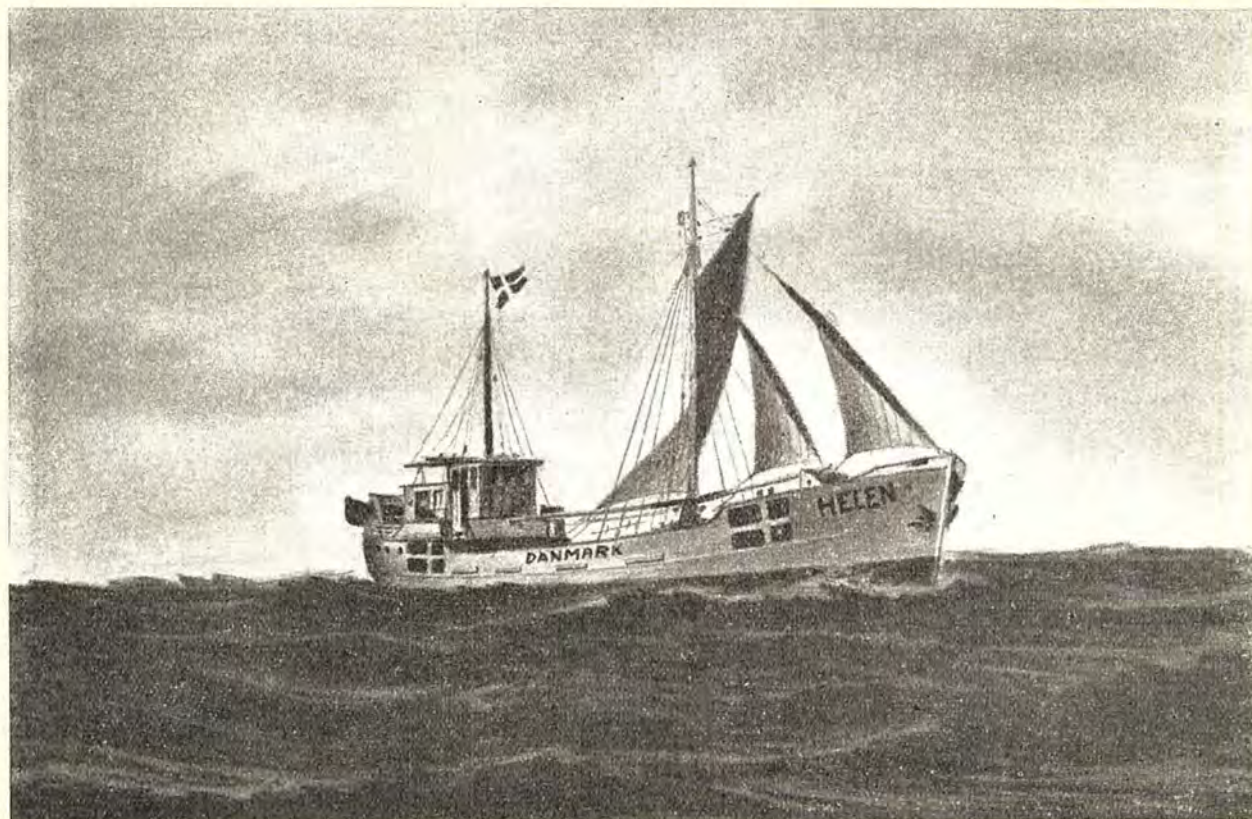
M/S »Helen« af Odense. Bygget 1937 i Holland. Typen paa de moderne Staal-Motorskibe til Nord- og Østersofart, hvor Sejlene kun er Støttesejl idet Motoren er Hoveddrivkraften. Gode Fartøjer med god Lasteevne. »Helen« laster 178 Tons. Efter Tegning af O. Stoltenberg, Kalundborg.
