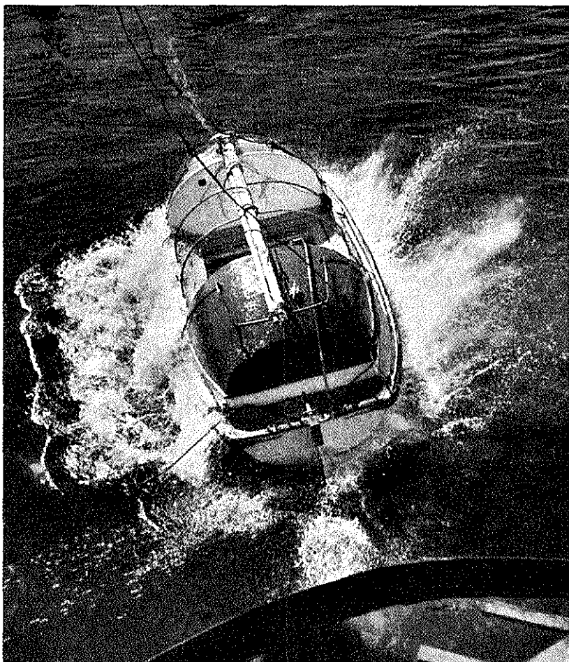
De selvrejsende Kræfter slynger øjeblikkelig Baaden rundt paa ret Køl fra et hvil-kensomhelst Udgangspunkt med en saadan Fart og Kraft, at Skummet staar om Baaden.
