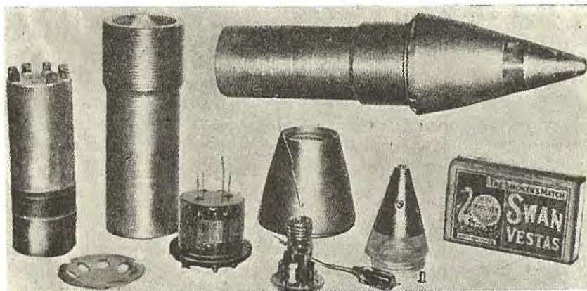
Granaten med Radiolocation. Øverst tilhøjre ses den samlet, og nedenunder adskilt. Tændstikæskan skal tjene til Størrelsessammenligning.
