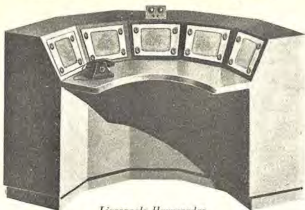
Liverpools Havneradar. Aflæsningscentralen med dens fem Skærme.
