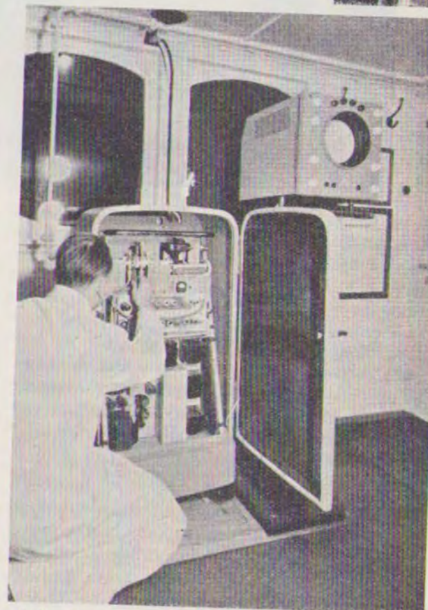
Et kig ind i sender/modtager-kabinettet. På billedet foroven ses radar-antennen. Skærmen roterer med en hastighed af 12 omdr./min.
