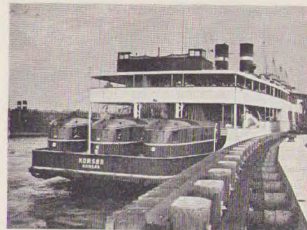
Færgen „Korsør“ klar til afgang med hele 3 lyntog om bord. „Korsør“ er Danmarks første motordrevne færge.
