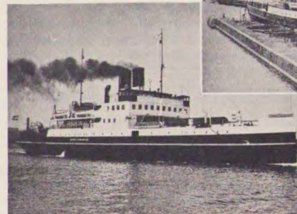
Hjuldampfærge „Prinsesse Alexandrine“. Bygget 1903 af Schichau i Elbing som enkeltsporet færge. Billedet viser skibet før ombygningen.
