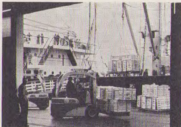
Trucks med gaffler har blot at løfte den særlige platform med godset, som er svinget udover skibssiden, og derefter befordre det videre
