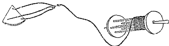
Håndlog med flynder, line, rulle og logglas, som i gamle dage benyttedes til måling af skibets fart.
