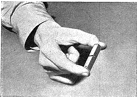
Prøvestykket til slagprøvningen. Understøttet i begge ender rammes prøvelegemet af et pendul på siden modsat kærven. A Charpy test piece.
