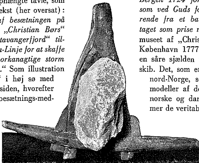
Norsk „krabbe“-anker bestående af en træ-omsluttet sten.
