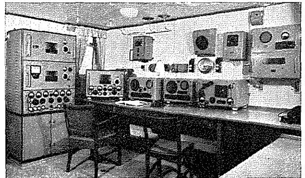
Billedet viser en radiostation i et moderne dansk lastskib, fra venstre ses hovedsender, på bordet nødsender, hovedmodtager, nødmodtager og telefonisender, yderst til højre på skoddet er autoalarmapparatet anbragt (Elektromekano A/S).
