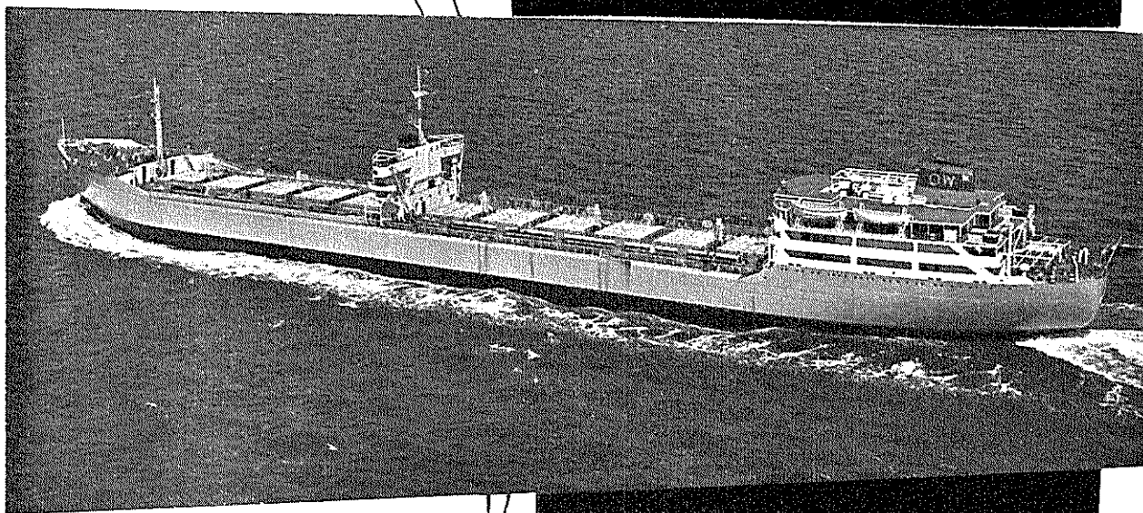
Lastlugerne løftes med hydraulisk kraft — hurtigt og bekvemt.
