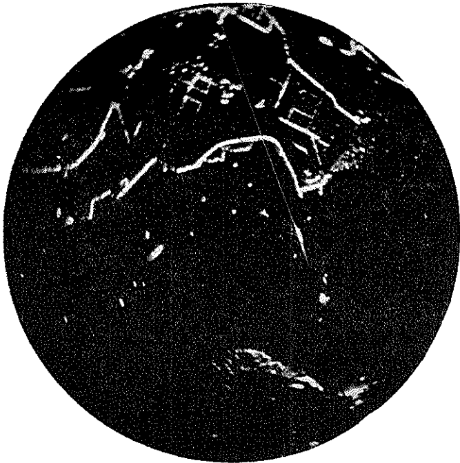
Her styrer „eget“ skib 340 grader og nærmer sig en skarp bojning på Schelden ved Bat. Man ser kanalen med dens bojer til bagbord for eget skib. Et stort fartøj går her op gennem kanalen. Uden for bojerne om bagbord ses et mindre skib. Agten for eget skib bevæger et større og et mindre skib sig i samme retning som „vi“ selv. Mål, der bevæger sig, ses som kometer med en hale efter sig.
