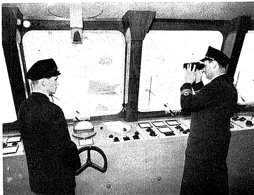
„Trelleborg“ har KAMEWA-propellere, der kan indstilles direkte fra kommandobroen, som iøvrigt er udstyret med lige så mange instrumenter som en moderne trafikflyvemaskines kontrolbord. Rattet fylder ikke meget!
