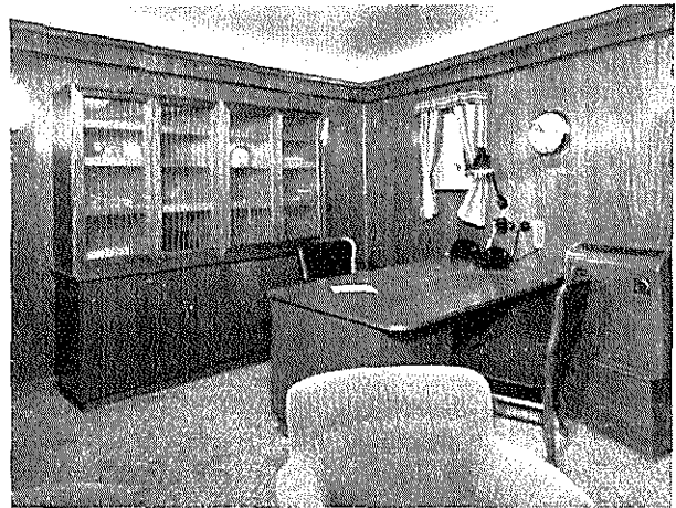
Interior fra m/s „Porthos“, som er udstyret med HI-PRES. Til højre i billedet ses HI-PRES kabinettet, hvor igennem den friske luft indblæses.
