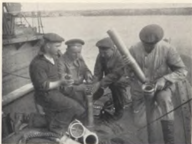
Artilleriemunition wird durch Einschrauben von Zündern scharfgemacht
